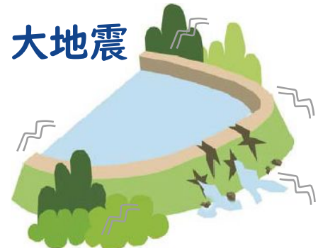
揺れや振動で堤防に亀裂が生じ漏水の原因となる。 地震の影響で地盤が液状化し強度が低下して決壊する。
