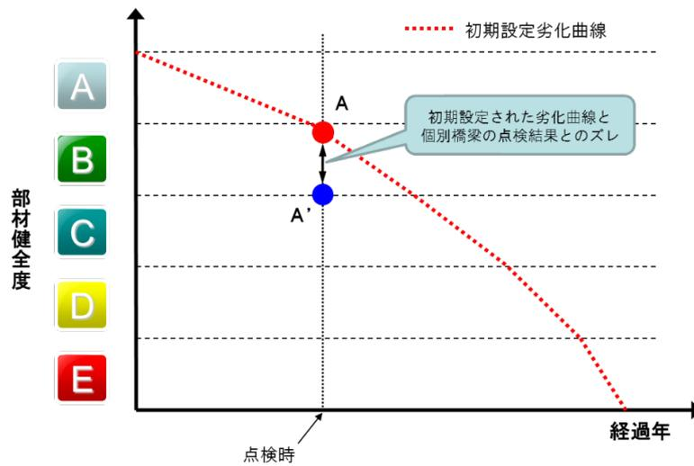
設定した劣化曲線から予測される健全度（A）と点検結果（A'）とのズレを補正する。
