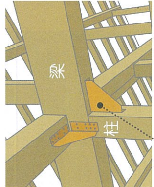
金物による補強
